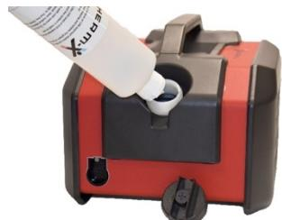
Una vez que haya preparado la mezcla de refrigerante, abra el depósito ubicado en la parte posterior del Therm-X y llénelo hasta la línea roja que hay en el interior del cuello de este. Es importante llenar el Therm-X hasta la línea roja.
