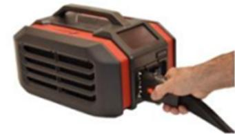
Fixez les raccords du tuyau à l'avant de la machine jusqu'à ce que vous entendiez un « clic ».
